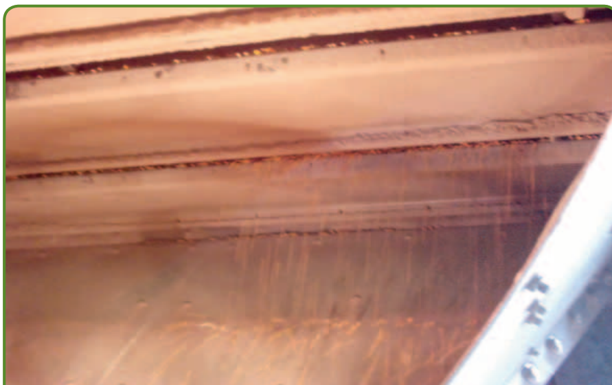
1. kép Jól látható a folyamatos „csorgás” az üritőszerkezetnél, ami a 4. ábra 2. és 3. oszlopában mutatkozó alacsonyabb maghőmérsékletet, a kiadagolt terményben pedig jelentős nedvességtartalom-eltérést okozott.
