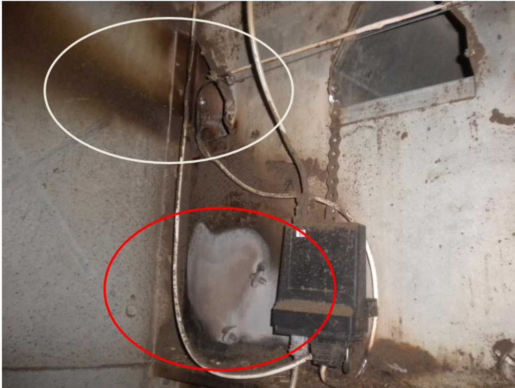
4. ábra. A tűzgócot pirossal jelöltük, itt izzott a lemez, az elszíneződés is erre utal. Felül pedig fehérrel jeleztük a félcsatornát, ahol a kicsapó láng elégette a kábelt, bekormozta az oldalfalat is (Forrás:www.terményszárítás.hu)
