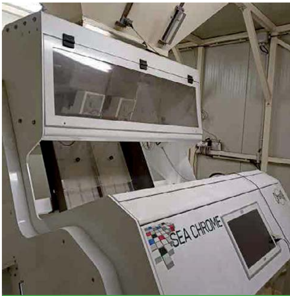
Csatornánként 2-2 db RGB és 1-1 db NIR kamerával felszerelt CIBMBRIA szín szerinti osztályozógép
